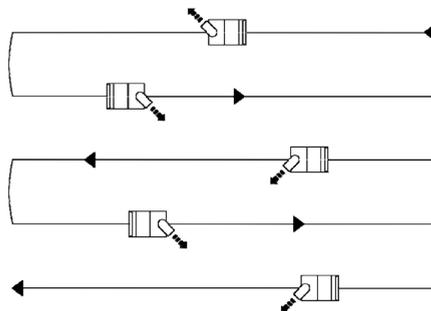
Начните работу по очистке и двигайтесь согласно схеме. Передвигайте снегоборщик вперед достаточно медленно, для полной очистки. Высота снежного покрова определяют скорость передвижения. Всегда держите шнур электропитания на очищенной стороне.
