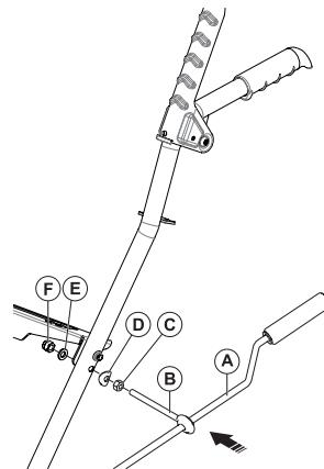
Присоедините рукоятку (А) поворотного желоба к левой ручке, при помощи крепежных элементов - бокс № 5: (С) гайка с шайбой M8 – 1 шт.; (Д) фигурная шайба D8 – 1 шт.; (Е) шайба D8 – 1 шт.; (Е) гайка M8 – 1 шт.
