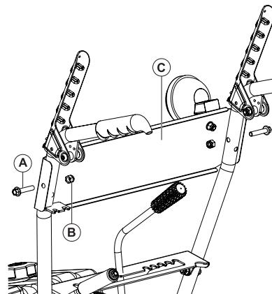
Прикрепите панель управления (C) к рукояткам используйте элементы крепежа из бокса №6: (A) болт 8x40 – 2 шт.; (B) гайка M8 – 2 шт.
