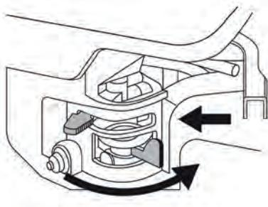
**Примечание!** Для повторного запуска горячего двигателя возможно оставить рычаг воздушной заслонки в положении «**ОТКРЫТО**».
