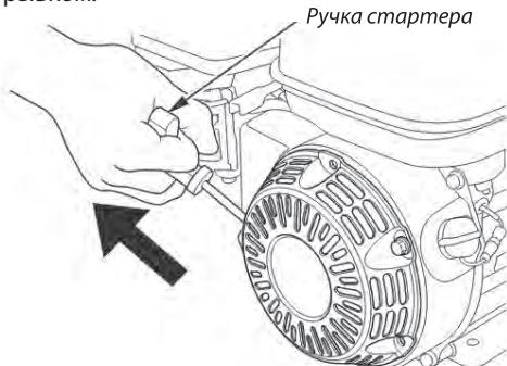
**Примечание!** Не рекомендуется вытягивать шнур стартера максимально (на всю длину), а также резко не отпускайте его при повторной попытке завести двигатель, удерживая рукоятку, плавно верните его в исходное положение.
