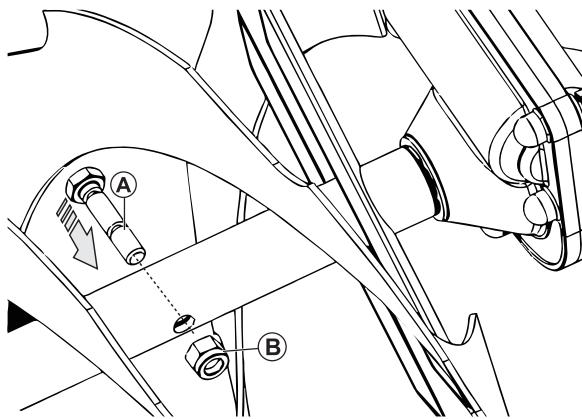
Шнеки крепятся к валу с помощью предохранительных (резьбовых) штифтов. В случае столкновения шнека с посторонним предметом или ледяным затором, штифты срезаются и шнек перестает вращаться, предотвращая повреждения других частей снегоуборщика.
